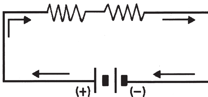
Resistencias conectadas en serie.
